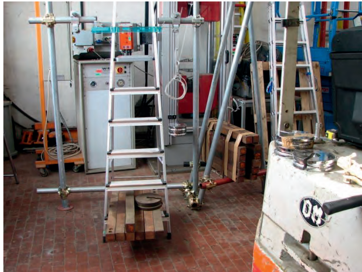
Figura 4.3 - 1 Prova di instabilità laterale su scala doppia
