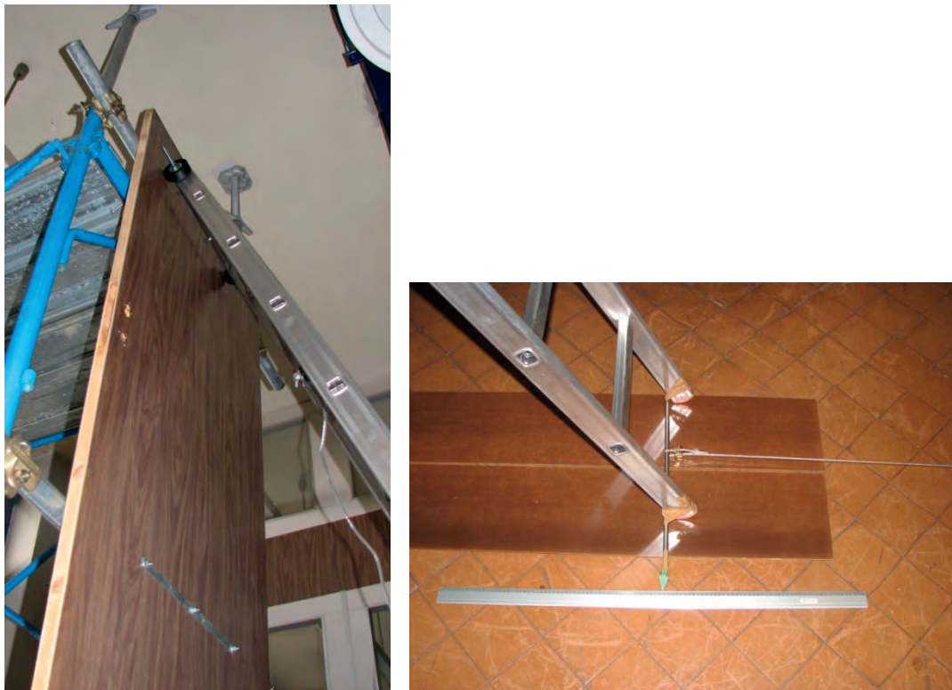
Figura 4.2.1-4 Particolare del ruotino in sommità e del sistema di misurazione della distanza di scivolamento
