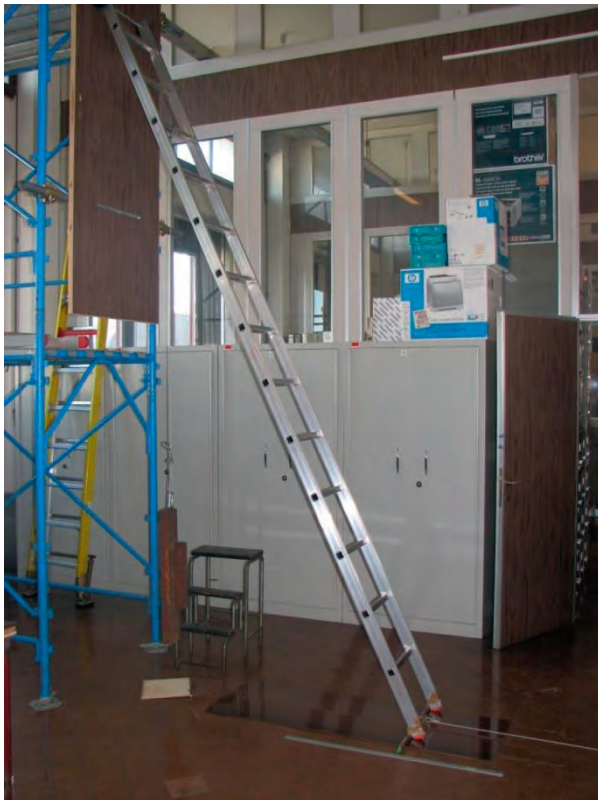
Figura 4.2.1-2 Scala a tronco unico, superficie alla base in HPL e tiro alla base
