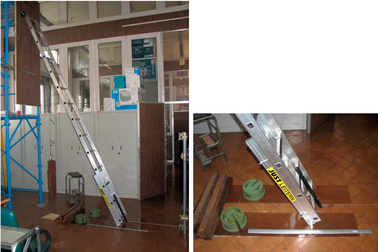
Figura 4.2.1-3 Scala con tronchetto, ruotino in sommità, superficie di prova in HPL e tiro alla base
