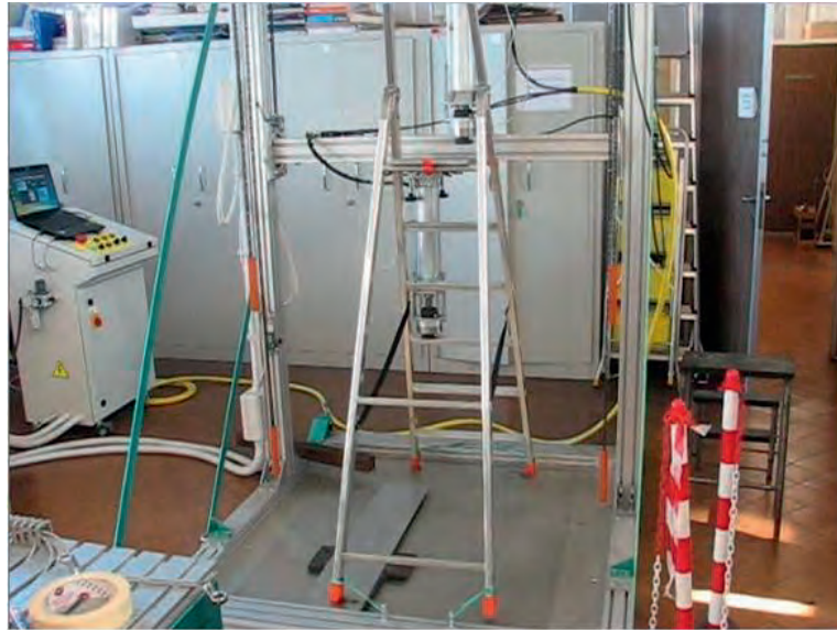
Figura 5.2 – 3 - Attrezzatura di prova per test di durabilità
