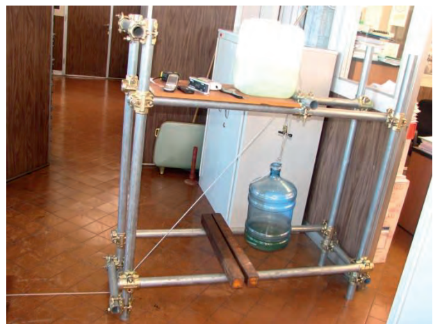
Figura 4.2.1-2 Scala a tronco unico, superficie alla base in HPL e tiro alla base
